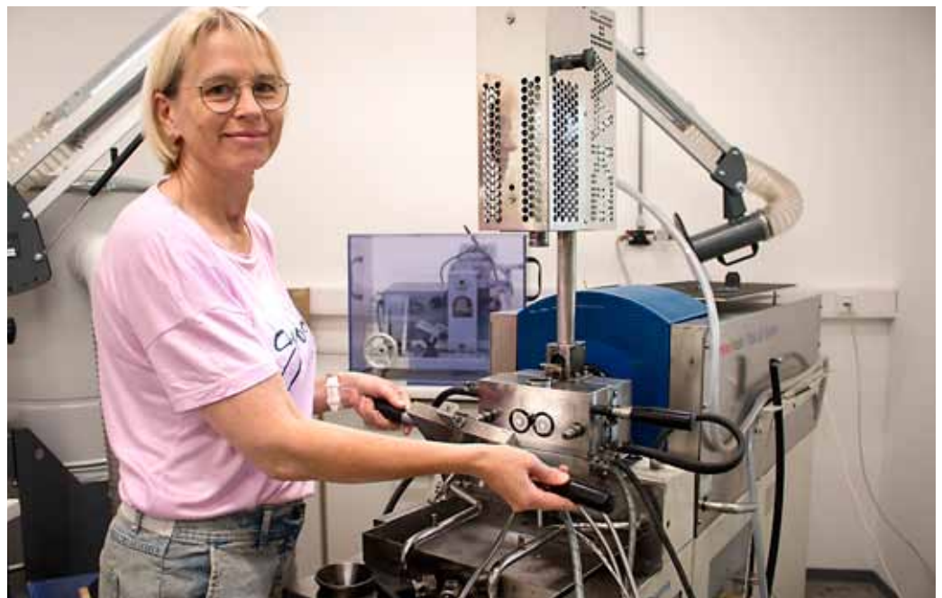
Dr. Katja Oßwald ist Kunststoffingenieurin bei der Polymer Service GmbH Merseburg. Hier steht sie an der Maschine, die Materialmischungen für Prüfplatten herstellt.
