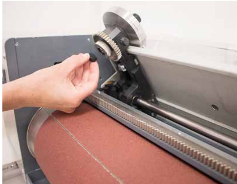
An einem rotierenden Schleifpapier-Zylinder wird auf einer Strecke von 40 Metern der Materialabrieb ermittelt.
