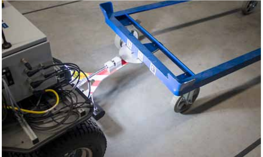
Über einen QR-Code findet das Schleppfahrzeug den Anhänger und koppelt sich selbständig an.
